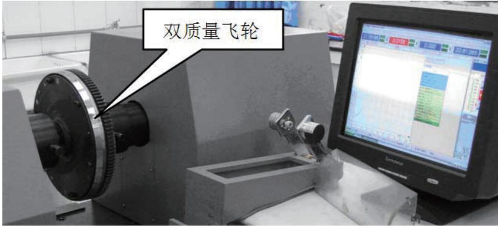
图11 转矩扭转角台架试验
