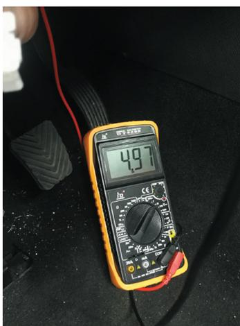
脚电压逐渐变大, 3 号逐渐变小, 在任何一个位置时, 两根针脚电压加起接近 5V, 则正常。
