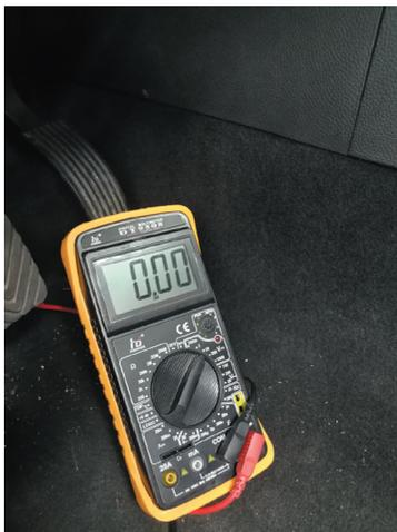
图 13 针脚 4 电压
